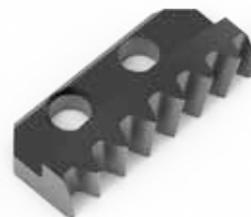
Zahnsegmente sorgen für eine formschlüssige Verbindung zwischen Führungs- und Exzenterring und verhindern somit ein ungewolltes Verstellen des Bearbeitungsdurchmesser. Zahnsegmente werden hauptsächlich dann verwendet, wenn die Schneidsysteme reversierend eingesetzt oder die Werkzeugspindeln nach dem Gewinde-schneiden abrupt abgestoppt werden.
