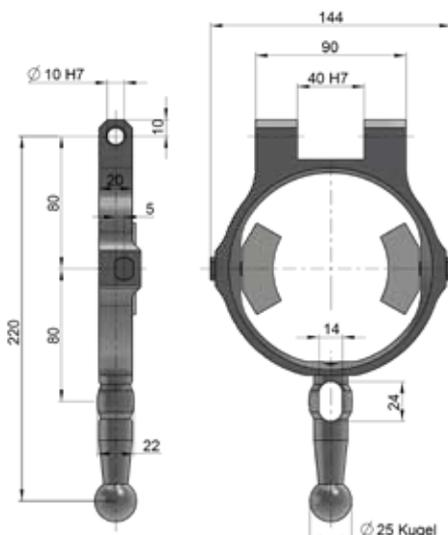
Zahnsegmente sorgen für eine formschlüssige Verbindung zwischen Führungs- und Exzenterring und verhindern somit ein ungewolltes Verstellen des Bearbeitungsdurchmesser. Zahnsegmente werden hauptsächlich dann verwendet, wenn die Schneidsysteme reversierend eingesetzt oder die Werkzeugspindeln nach dem Gewinde-schneiden abrupt abgestoppt werden.
